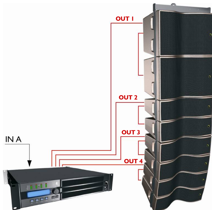
図 4: LA4JP の A IN に KILO 2 台 + KIVA 6 台を接続したラインソースアレー
