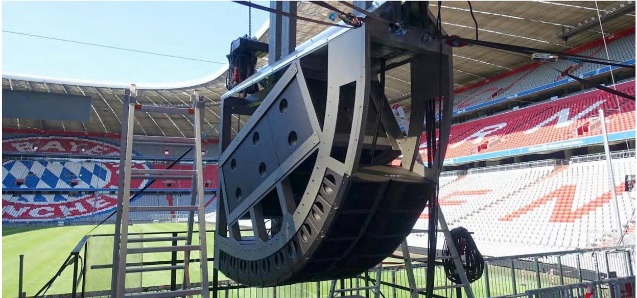
また、重量制限もありました。「スタジアムの屋根に対する厳しい制限のため、8インチのレイシステムのみが検討されました。」と、Müller-BBMのサウンドエンジニア、ハラルド・フリッシ氏は加えて述べます。「L-AcousticsのKaraシステムは、重量、カバレッジの精度、得られる音圧レベルおよび音質の比率は理想に近いと言えます。」
