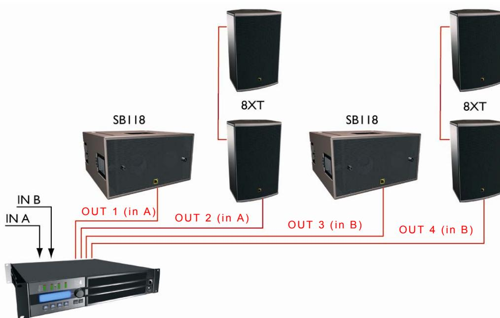
図 6 : SB118 (2 台) と 8XT (4 台) を LA4 コントローラー 1 台に接続する
