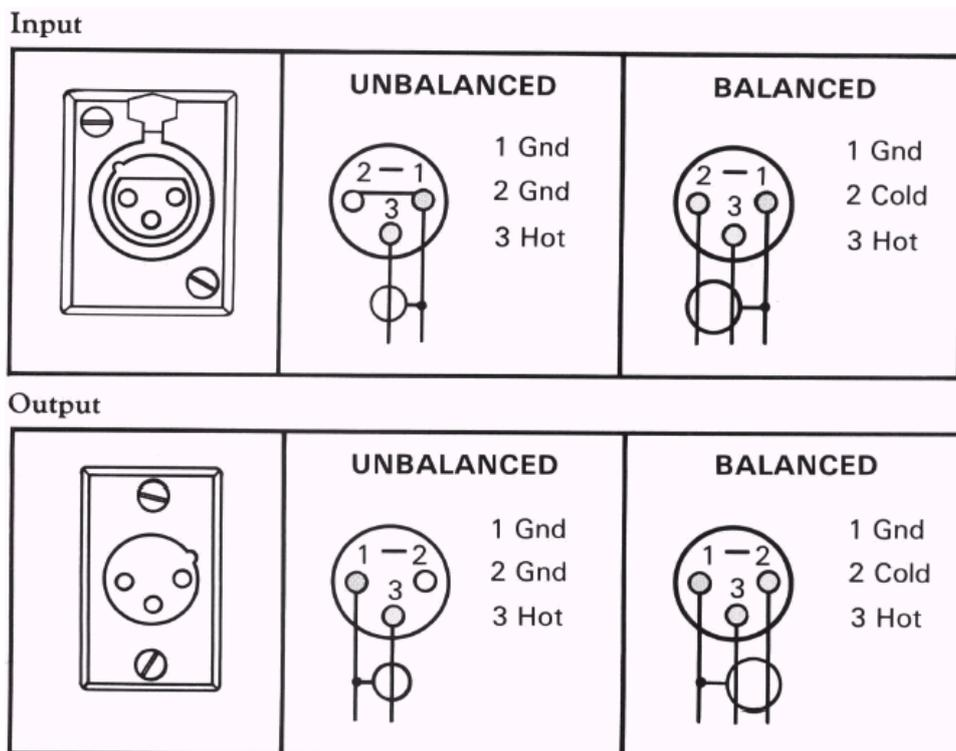
注) 完全なバランスのシステムを接続する時、PIN-2 か PIN-3 のどちらでも HOT 端子にすることが出来ます。
