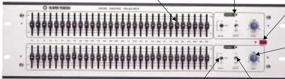
電源スイッチは、2極タイプでライブと中立の導体の両方を分離しています。電源を入れると赤いLEDが点灯します。
