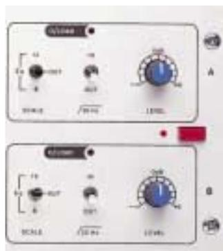
操作を柔軟にするため可変フェーダー、すなわち6dB又は12dBのカット又はブースト、を組み入れてあります。この機能（スケール）は、信号経路からグラフィックイコライザーセクションを無音で取除くバイパススイッチと結合しています。サブソニックの18 dB/オクターブロールオフフィルター（-3dB@30Hz）は、各チャンネルからスイッチでON/OFFすることが出来ます。
