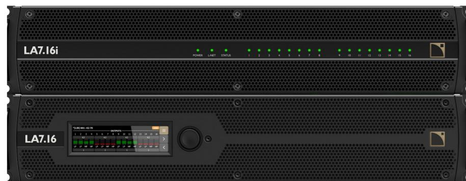
LA7.16とLA7.16iは、アンプとプロセッシングの高離散化のメリットを受けるアプリケーションにユニークなソリューションを提供する16 x 16アーキテクチャーのアンプリファイドコントローラーです。16の出力チャンネルは、それぞれ1300W / 8Ω、1100W / 4Ωの出力を備え、ほとんどのL-Acousticsスピーカーを数多くドライブできます。
