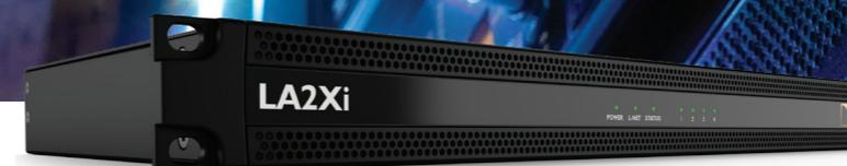
固定設備向の4チャンネルアンプリファイドコントローラーであるLA2Xiは、小型スピーカーのパワーに適合するよう設計されていますが、低音圧キャパビリティ（4 x 4シングルエンドモード）のほか、フル音圧キャパビリティ（4 x 3、4 x 2、4 x 1ブリッジモード）により大型スピーカーにも対応します。
