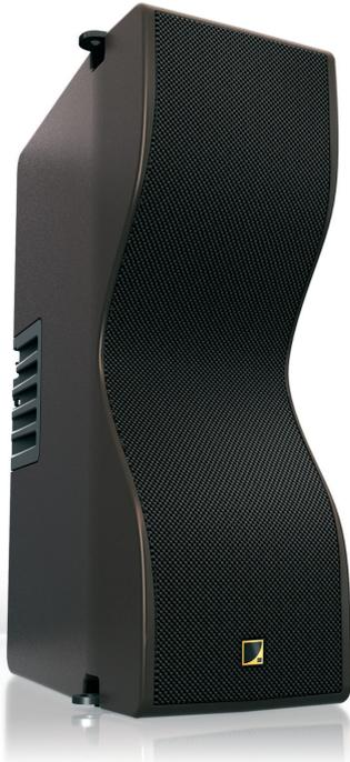
2Wayパッシブで公称インピーダンスは8Ω、バスレフ型エンクロージャーには6.5インチのドライバが2つと、1.5インチのHFダイアフラム・コンプレッションドライバがDOSC®ウェーブガイドと共にマウントされ、トランスデューサーはV字型に配置されています。キャビネットは、優れたメカニズムと音響特性を持つ、独自の合成素材で作られています。これはバルト海産のカバの合板に非常によく似ていますが、湿度に強いという利点を持ち合わせています。また、3点のリギングシステムがキャビネットに組み込まれています。
