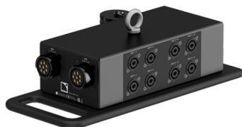
**BOB32:** ASC32コネクタ1個をCA-COMコネクタ2個とNeutrik™ NL4コネクタ8個に変換するブレイクアウトボックスです。既存のSPケーブルやCA-COMケーブルと併用することで、数多くのL-Acousticsのスピーカーを接続するために効率的な方法となります。このフレキシブルなアクセサリは、地上での使用と、2つのM8リングポイントに付属の2つのアイボルトを使用してフライングさせることも可能です。
