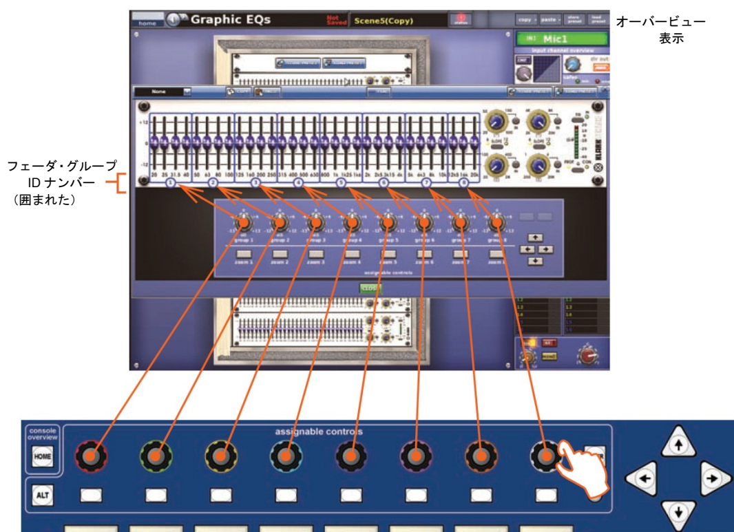
図 13: Graphic EQs 画面のオーバービュー・ディスプレイのフェーダ・グループ・コントロールつまみの割り当て
