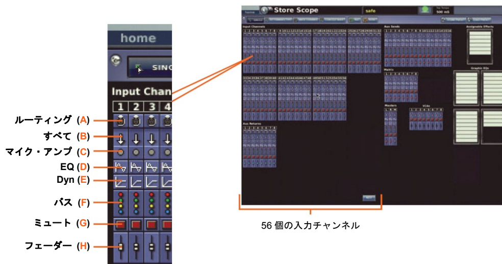
図 30: 入力チャンネル毎のパラメータ・セクション
