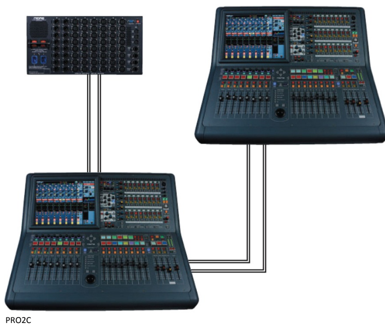
DL251 スプリット・ネットワークを使用したデュアル PRO2C FOH & MON システム
