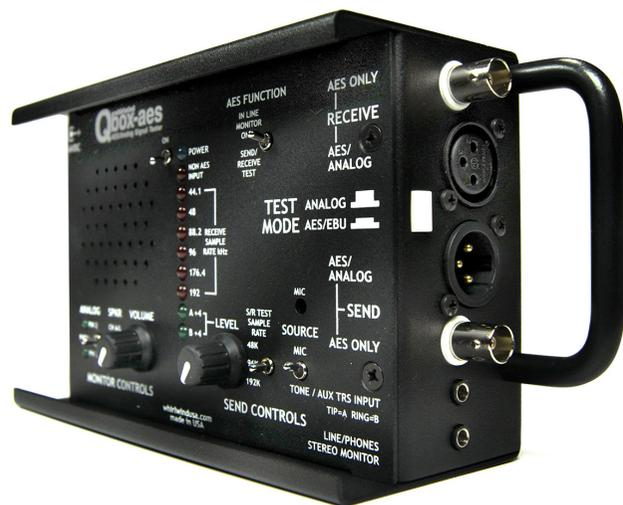
Qbox-aes は、デジタル AES-3、S/PDIF およびアナログオーディオ信号のトラブルシューティングのための多目的テストデバイスです。Send セクションと Receive/Monitor セクションの2つのセクションで構成されています。テストモードスイッチにより、アナログまたは AES のテスト操作を選択します。オーディオは内蔵スピーカーまたは 3.5 mm ジャックを通じてデコードされて出力されます。テスト信号は複数のソースから生成することができます。また、AES データストリームのインラインモニターも可能で、通過する信号を変更することはありません。
