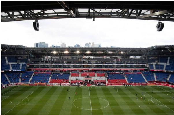
今回導入したシステムは、主に96台のA15i Focusで構成されており、必要に応じて12台のA15i Wideエンクロージャーで垂直方向のカバレッジを増やすことができます。北、南、東の各ゾーンに7台のA15iによる4つのアレイと、西ゾーンに6台のA15iによる4つのアレイを配置し、それぞれに3台のSB18Iliを組み合わせてLFインパクトを高める設計になりました。北西と南西のコーナーにそれぞれ2台のA15i Focusを配置した小型のコーナーフィルアレイを使用してボウルシステムを完成させ、観客のリスニングエリアを完全にカバーし均一なSPL分布を確保します。
