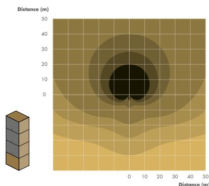
▶ 4×SB15mブロックのSPLマッピング。スタンダード(左図)とカーディオイド(右図)。3 dBステップで同一SPLをカラースケール表示。
