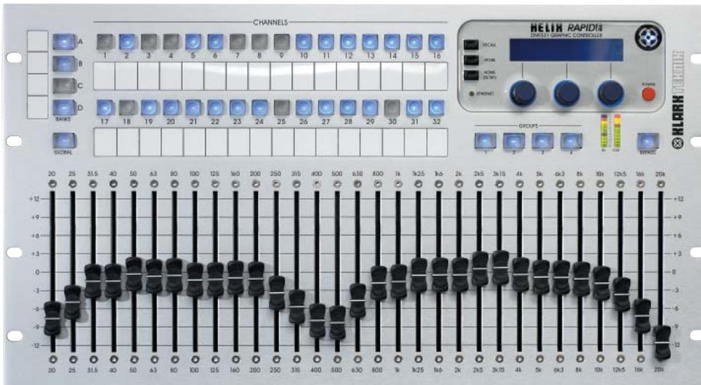
DN9331 は 6U、19 インチ・ラックで、モーター化させたフェーダー・リモート・コントロールを採用しています。XL8 のオンボード用グラフィック EQ を 1 本の Ethernet ケーブルで接続し、ソロ・トラッキング・システム (STS) を経由して、すべてオンボード・アサイン可能なグラフィック・イコライザーを簡単にリアル・タイムにコントロールすることができます。
