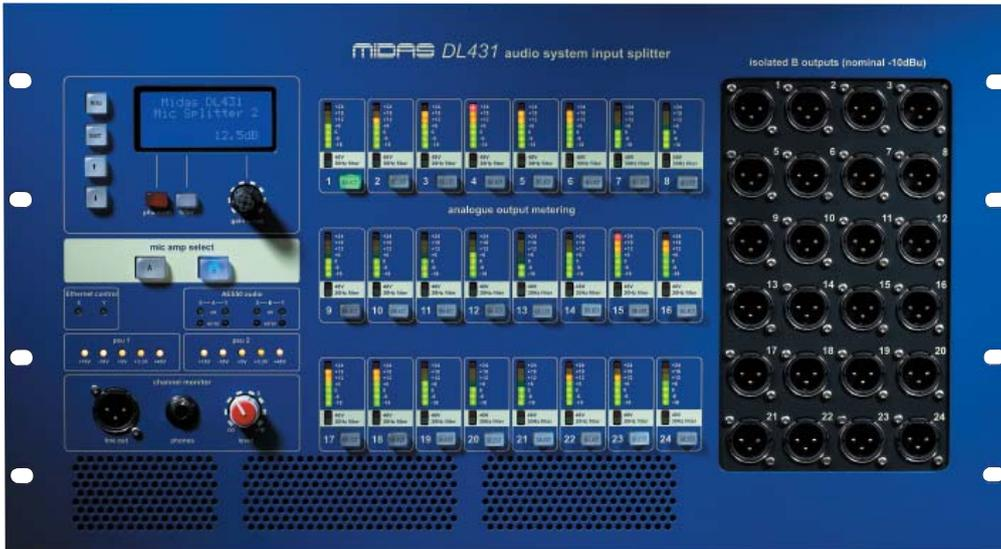
DL431 は 6U、19 インチ・ラックで、24 マイク / ラインインプットを供給します。各インプットは 3 個の独立したプリアンプを搭載し、2 個は別々のリモートとローカルのゲイン・コントロールができ、3 個目のゲインは固定されています。ゲイン・コントロール可能な 2 個のプリアンプは、別の ADC に供給され、デジタル・オーディオはネットワークに送られます。4 個の独立した AES50 アウトプットは、デュアル・リダンダント・デジタル・オーディオを FOH と XL8 モニターシステムに供給しながら、サードパーティの AES50 デバイス（例、HD レコーダー）に DL461 ルーターを経由して、ルーティングする事が可能です。
