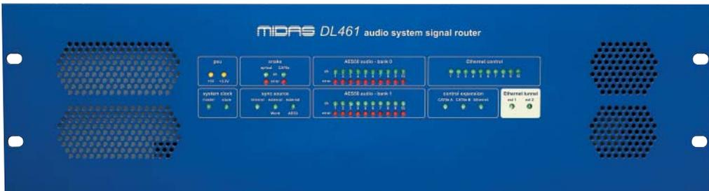
DL461は3U、19インチ・ラックで、ステージとコンソール間のリンクの役割をします、1本のCat6ケーブル(100メートル以下)、あるいは光ファイバー・リンク(最長500m)を使用することが出来ます。オーディオとコントロール接続を10台のDSPモジュールに行うと共に、10台すべてにデュアル・リダンダントAES50接続を行い、ローカルI/Oや、BNC、AES3コネクタにワード・クロックを提供するインターフェースを持ち、そしてEthernetデータを通すことが可能です。デュアル・リダンダントDL461はXL8システムに供給されます。
