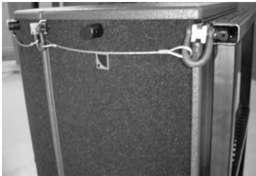
(7) 安全ワイヤーで ARCBUMP をアレーに固定する。 (フロントとリア、上下)。
