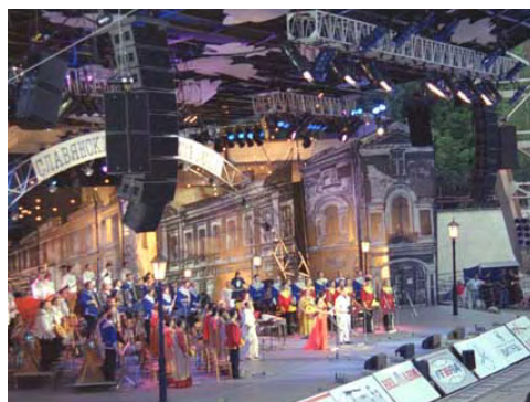
図 31：フライングした ARCS サイドフィル（片側 ARCS 2+2）とオフステージフィル
