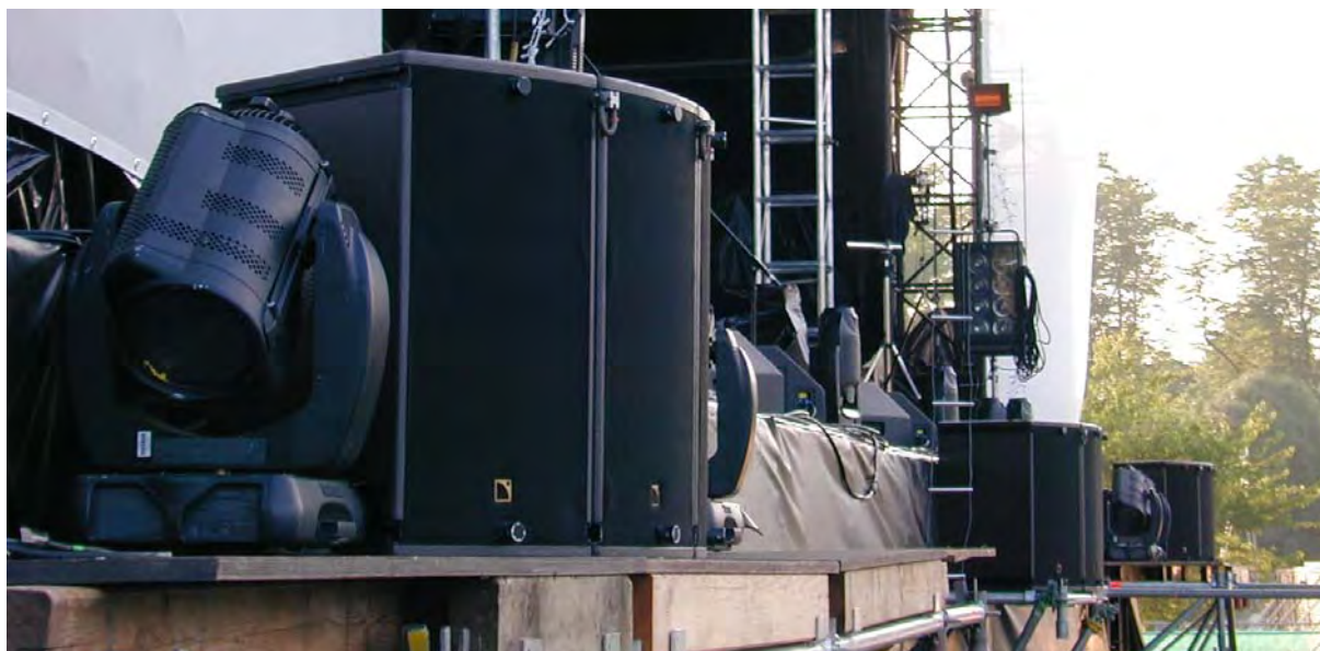
図 33 : 分散型 ARCS フィル（ARCS 4 台を LCR の 3 ヶ所に設置）
