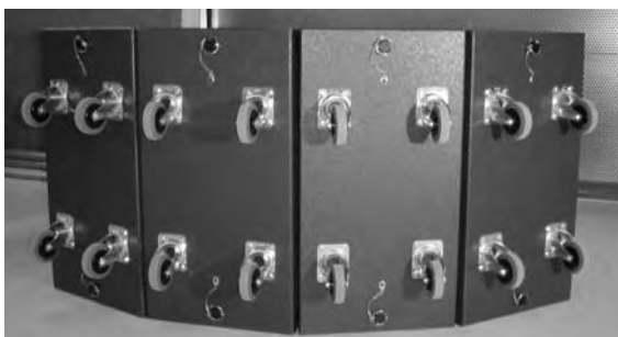
(3) 位置、方向決めを完了したエンクロージャー (リアのジャックプレートを基準にする。下にきていれば、カバレッジは-40/+20°)。
