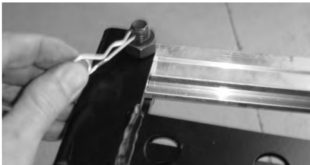
(11) ARCOUPL をロックナット、ボルト、コッターピンで固定する。
