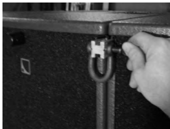
(8) フロントシャックルで ARCOUPL を固定する。
