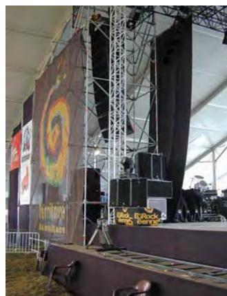
図 30：スタッキングした ARCS サイドフィル（ARCS×3、SB218×1）とステレオフロントフィル
