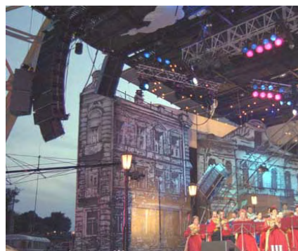
図 31：フライングした ARCS サイドフィル（片側 ARCS 2+2）とオフステージフィル
