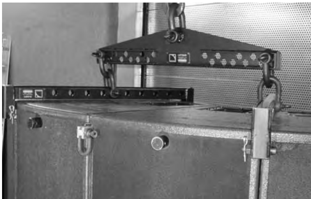
(9) 2本のBUMP3にLIFTBARを取り付ける(穴を選ぶ際はリギング一覧表(表14)を参照のこと)。
