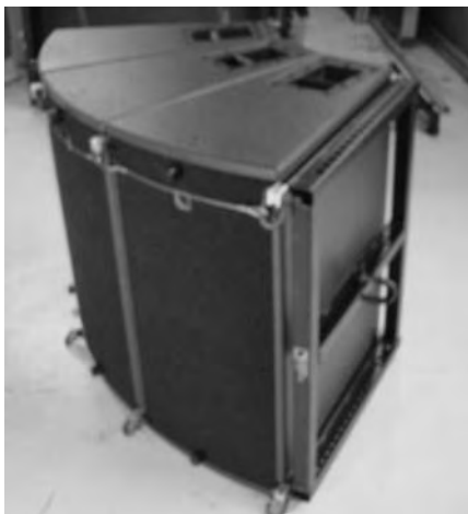
(9) サイドから見た図 (注：シャックルをスプレッダーバーの中央に付けて一点吊りにする。)
