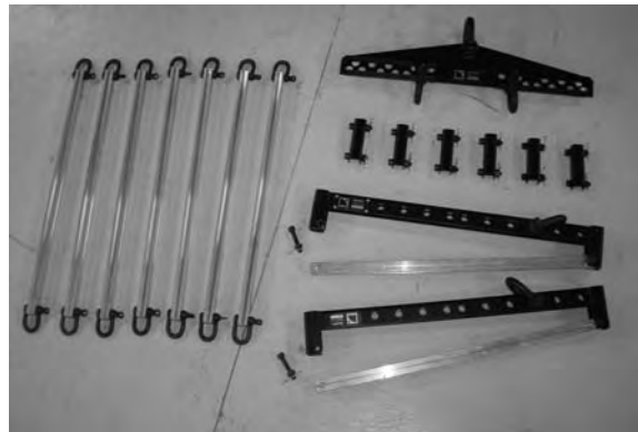
(2) リギングアクセサリ（ARCOUPL×10、BUMP3 ×2、LIFTBAR×1、ARCSTRAP×6、シャックル）
