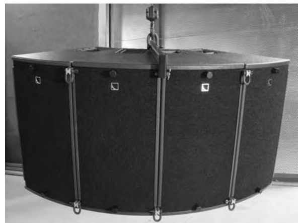
(14) フライイング準備完了 (表 14 のリギンガー一覧表を参照してアレーの傾斜角度、選択する穴を決める)
