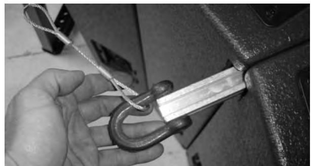
(2) ARCOUPL のシャックルに安全ワイヤーを取り付ける（フロント、リア、上、下）。
