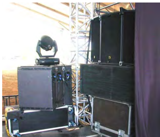
図 30：スタッキングした ARCS サイドフィル（ARCS×3、SB218×1）とステレオフロントフィル
