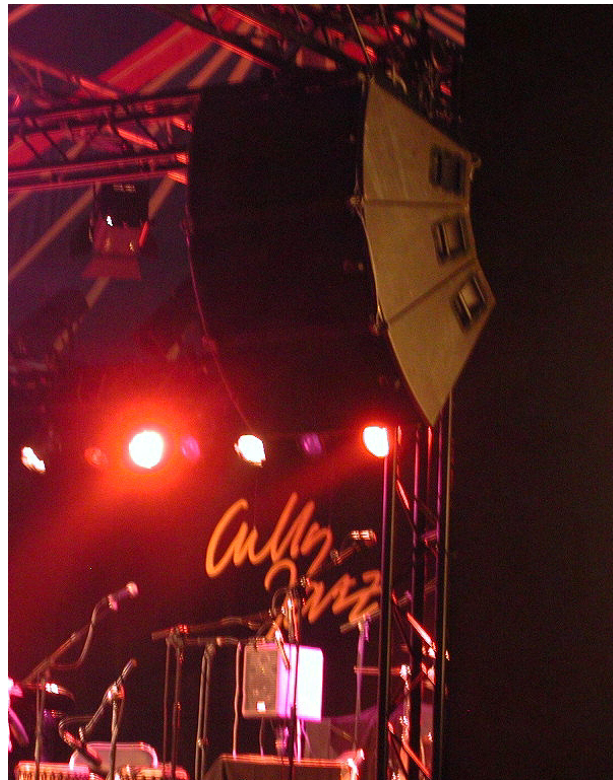
図 29：横向きでフライングした ARCS 縦型アレー
