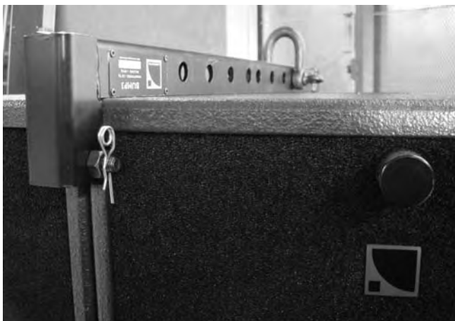
(13) コッターピンでフロントのロックナットとボルトを固定し、BUMP3 でピックアップを選ぶ。
