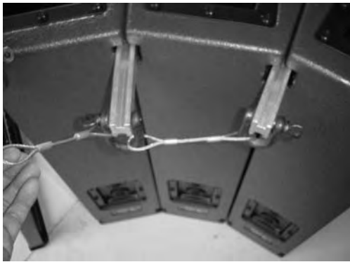
(3) 安全ワイヤーを付けた様子 (上部)
