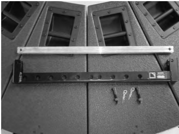
(9) BUMP3。シリアルナンバープレートをアレー前面に向ける。
