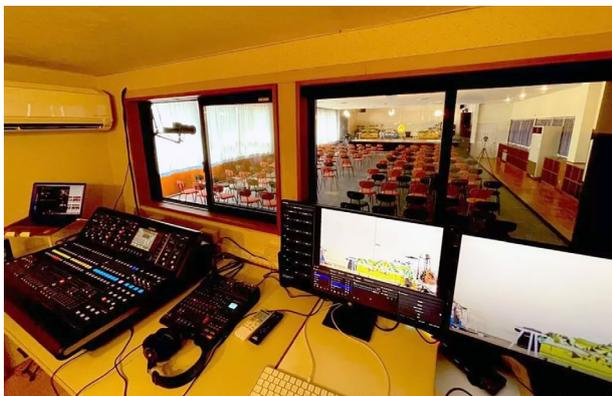
M32 LIVEは常設。ステージ(約9m×6m)の上下袖にはステージボックスDL16を一台ずつ配置し入出力を確保
