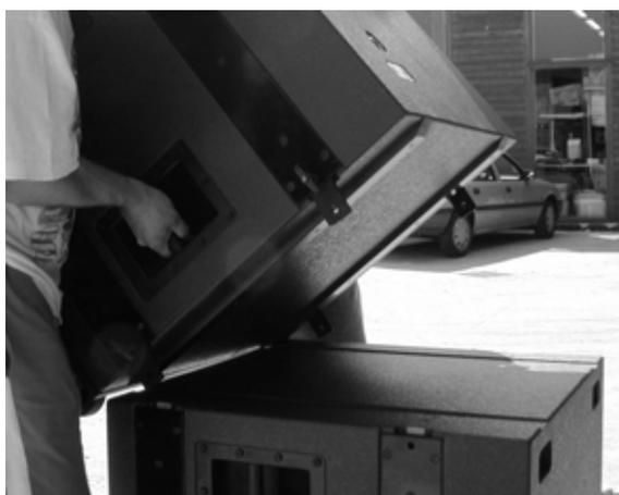
2 台目を定位置に置き、1 台目のリギングパネルと対応するように dV-ANGLESS を全 4 ヶ所に付ける。
