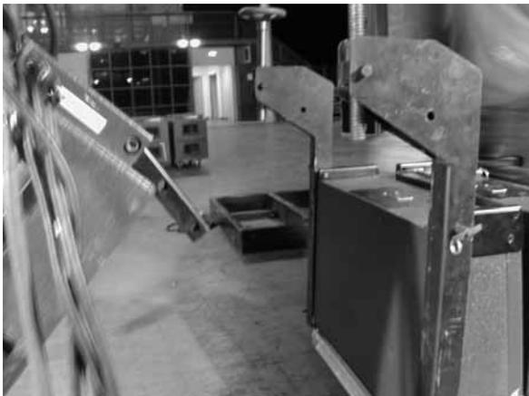
(iii) 最下 V-DOSC の回転脚を降ろした状態。最下エンクロージャーにはアングルストラップは付けなくていい。
