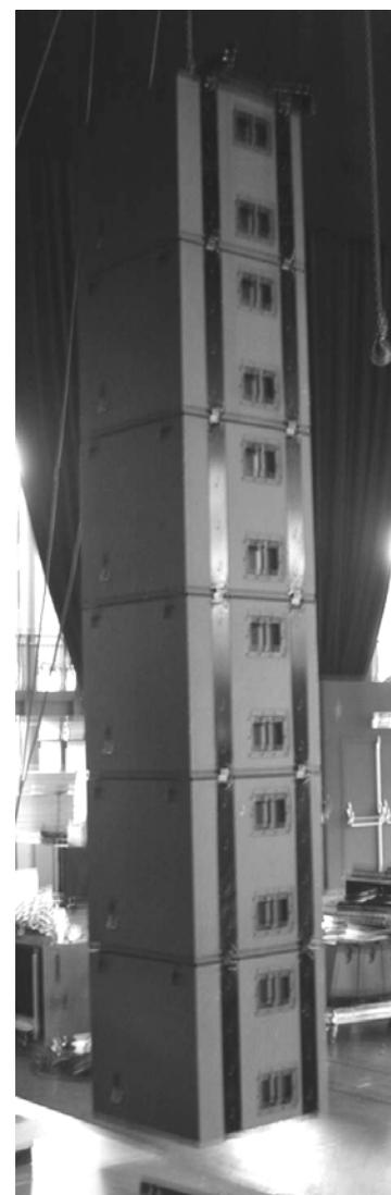
図 85: dV-SUB だけをリギングする
