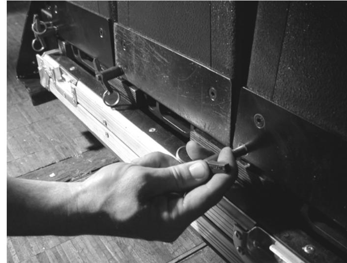
(ii) dV-DOSC 全キャビネットのフロント部に dV-PIN25 を挿し込む
