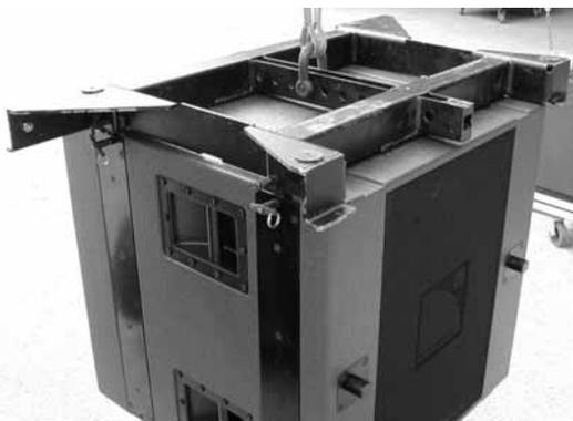
(iii) 1台目のエンクロージャーを吊り、2台目に dV-ANGLESS(4つ)を取り付けてから 1台目を下ろし、dV-PIN25 で固定する。これを繰り返す。
