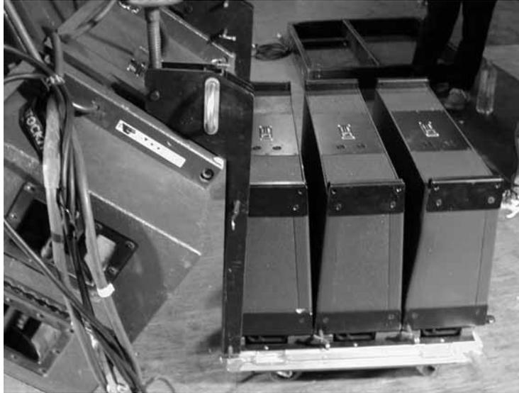
(v) U-PIN で dV-DOWN を取り付け、セーフティーピンでロックする。
