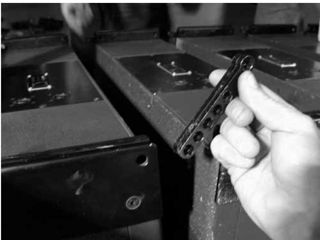
(iv) リアの全ヶ所に dV-ANGLE を付ける (ボール / タブ側が上の状態)
