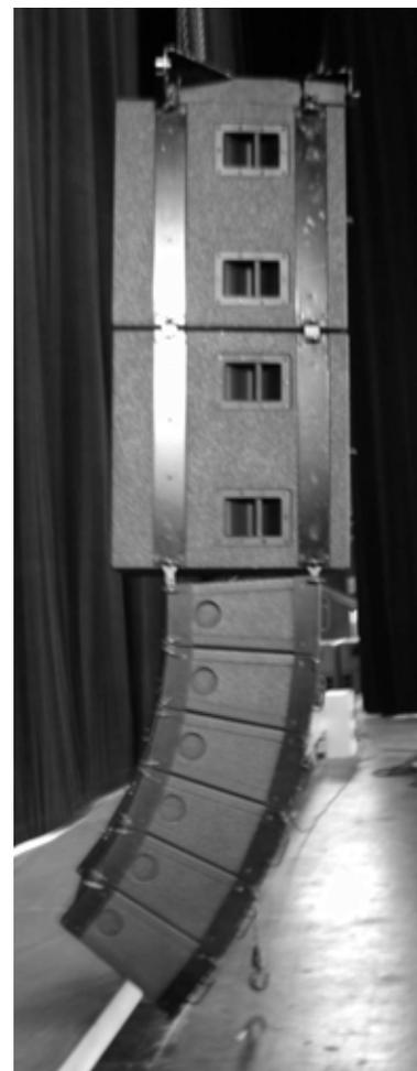
**図 88: dV-SUB の下に dV-DOSC をリギングする(大規模な構成 方法 2)**
