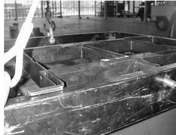
(iv) dV-PIN81 でロケーターピンを正しい位置に取り付ける
