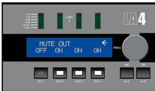
図 12: 出力 1 はアンミュート、他の 3 出力はミュートされた状態
