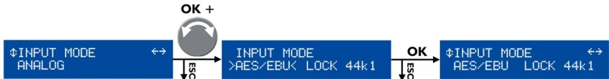
図 8: INPUT MODE の設定
