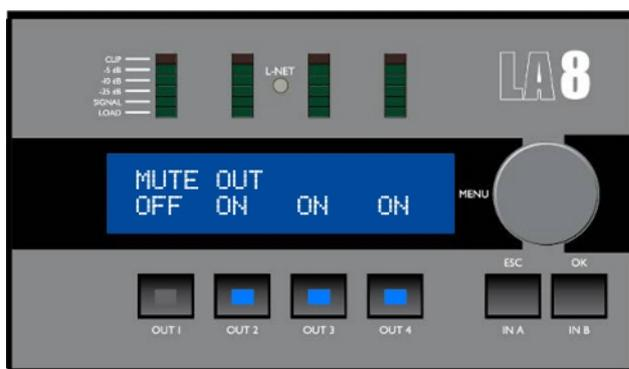
図 18 : 出力 1 はアンミュート、2 から 4 出力はミュートされた状態
