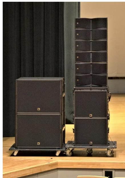
移動型スピーカー (片側) KIVAII x 6 + SB15m x 2 + SB18 x 2
