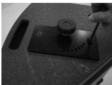
(3) ETR1のアダプタープレートを取り付ける
