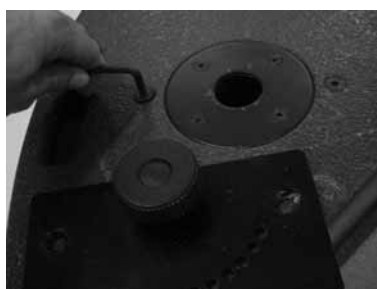
(2) アダプタープレートを取り付けるため、ETR1にあるネジをはずす(5mmのアレン・キー)
