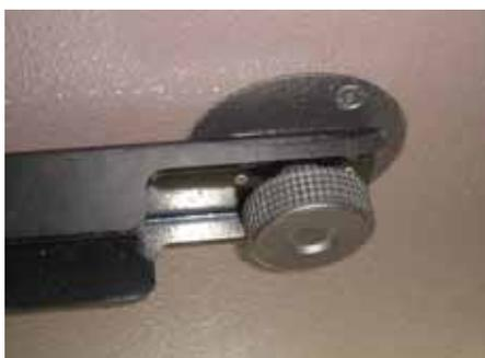
(7) SB15P の角度を調整し、傾斜調整ノブで固定する（調整ノブを締めると、ピボットアームのロッキングピンが自動的に U ブラケットを固定する）
