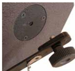
(4) (必要であれば) アダプタープレートのネジを取り、ピボットアームを正しい位置にセットする
